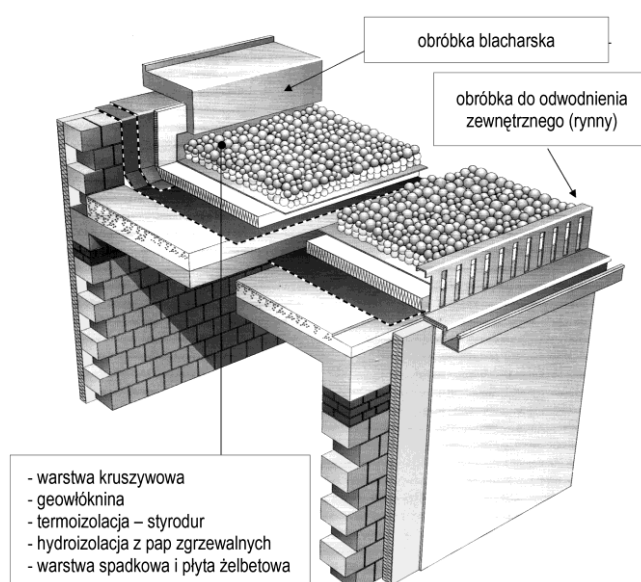
Rys. 28. Stropodach pełny odwrócony [5]
