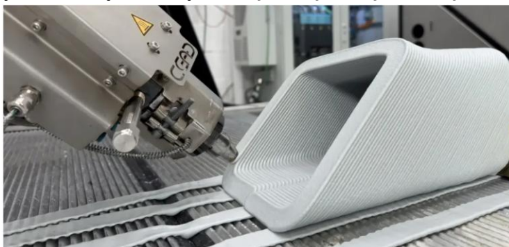
Rys. 10. Wielkogabarytowa drukarka 3D/robot drukujący firmy CEAD Group (CEAD Group - 3D printer, 2025).
