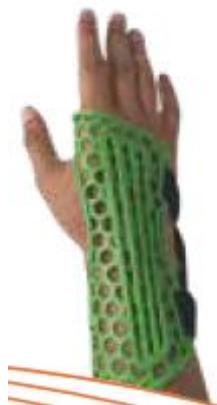
Rys. 6. Przykładowy wydruk ortozy z materiału PLACTIVE (COPPER 3D Company, n.d.).
