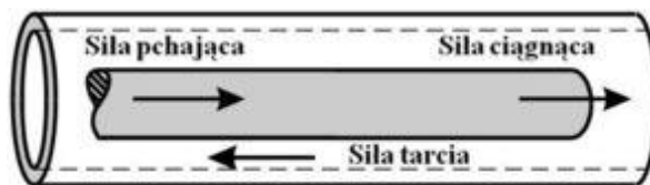
Rys. 5. Schemat sił działających na kabel (Andrzejewski, 2008)
