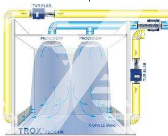
Rys. 6. Nawiew laminarny powietrza w pomieszczeniach czystych a) o niskiej turbulencji (tzw. LF), b) o ukierunkowanej niskiej turbulencji (PCD) [24].
