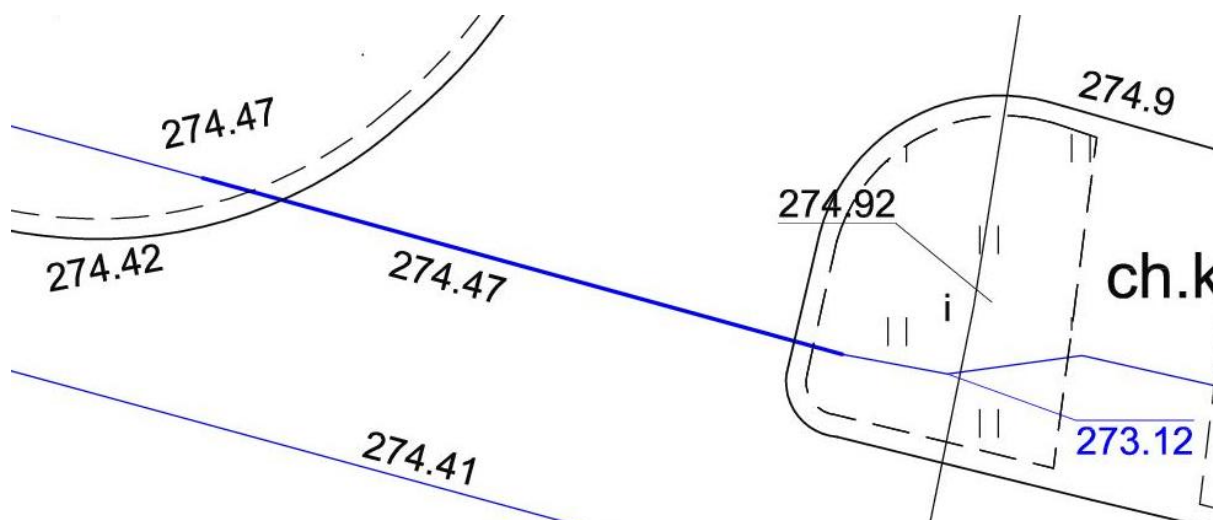
Rys. 3. Fragment mapy zasadniczej – rura osłonowa na wodociągu.
