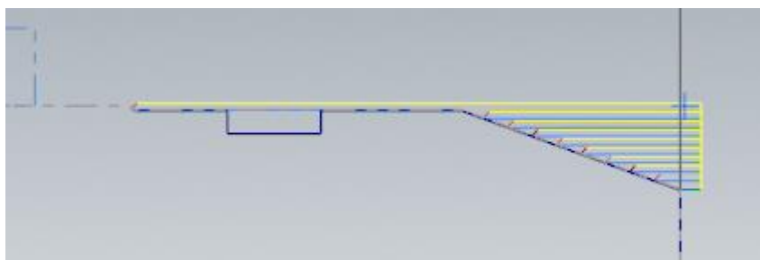
Rys. 84. Droga narzędzia przy obróbce zgrubnej.
