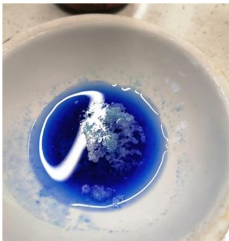
Rys. 3 Próba nr 2 po dodaniu \text{HNO}_3 i \text{NH}_4\text{OH}
