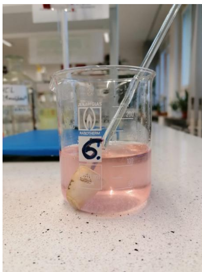
Rys. 5 Próba ze wskaźnikiem – po miareczkowaniu
