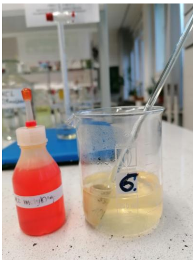
Rys. 4 Próba ze wskaźnikiem – przed miareczkowaniem
