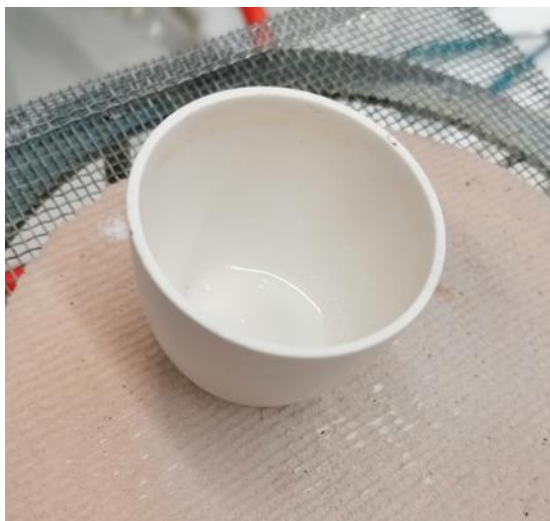
Rys. 1 Tygiel wraz z próbką szkła wodnego przed prażeniem
