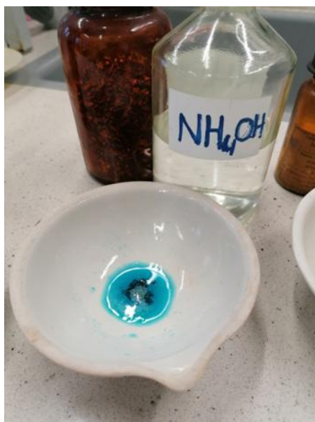
Rys. 2 Próba nr 2 po dodaniu \text{HNO}_3
