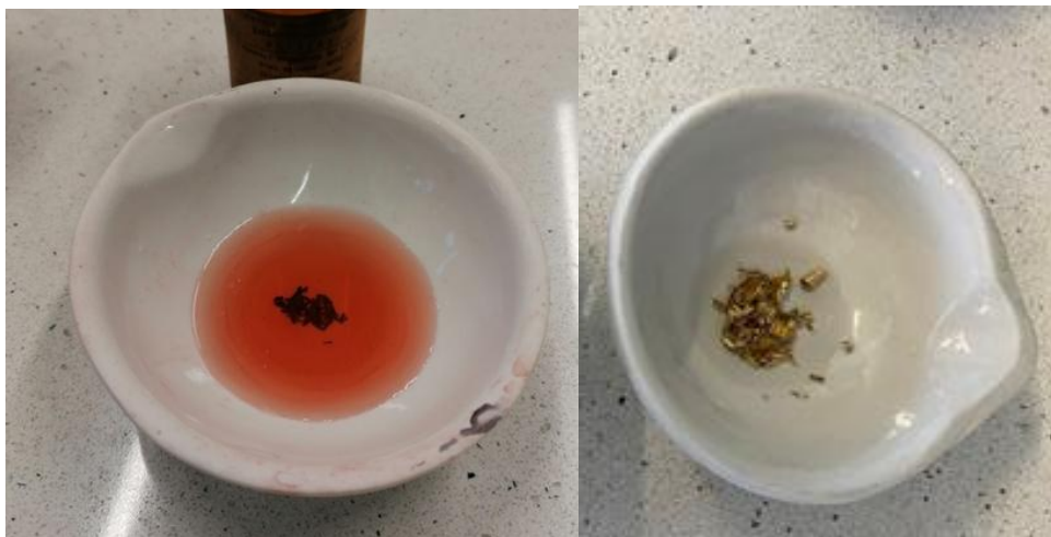
Rys. 1 Próba 1 (z lewej) i próba 2 (z prawej) po dodaniu KSCN
