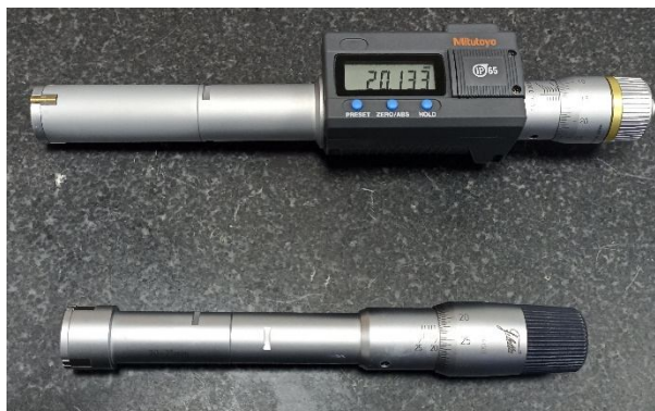
Rys. 31. Trójpunktowe średnicówki mikrometryczne o zakresie 20 – 25 mm.
