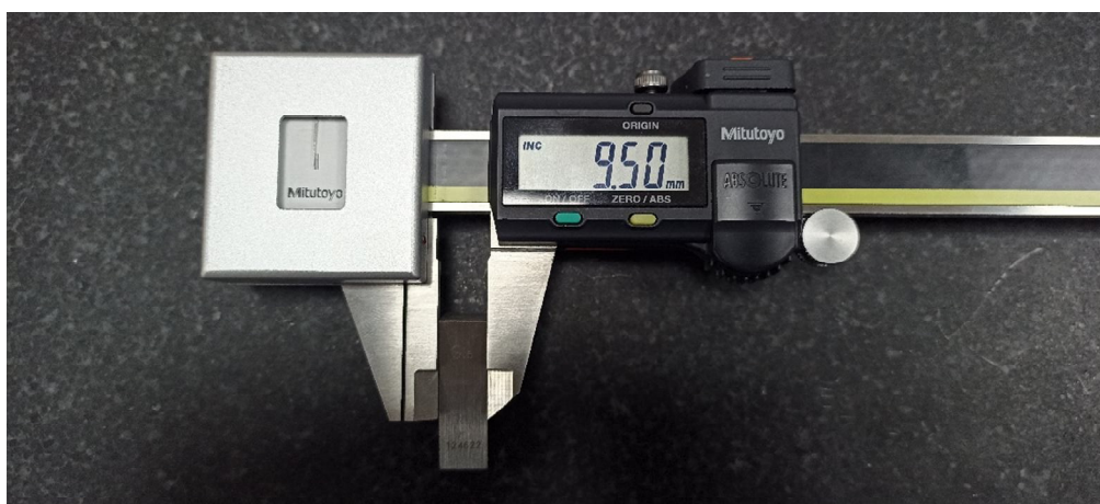
Rys. 17. Suwmiarka firmy Mitutoyo z analogową regulacją siły nacisku.
