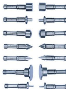
Rys. 27. Mikrometry specjalne, gdzie: a) mikromer ostrzowy, b) mikrometr do wieloklinów, c) mikrometr do rur, d) mikrometr punktowy, e) mikrometr do gwintów, f) mikrometr talerzykowy, g) mikrometr uniwersalny z wymiennymi końcówkami (Katalog przyrządów pomiarowych Mitutoyo - PL-20007 2024).
