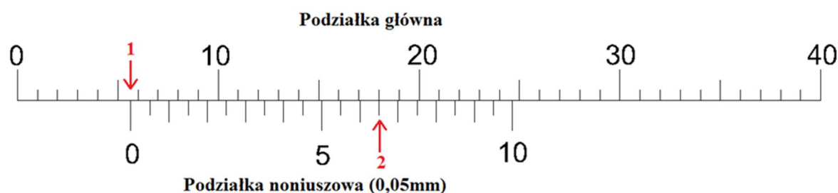
Rys. 8. Odczyt wyników pomiarowych z suwmiarki z noniuszem 0,05mm
