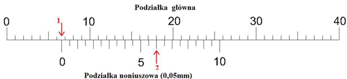
Rys. 7. Odczyt wyników pomiarowych z suwmiarki z noniuszem 0,05mm
