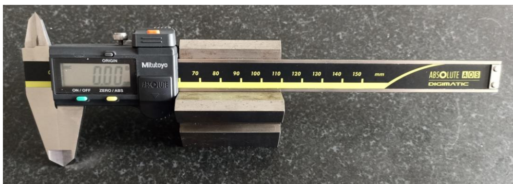
Rys. 9. Suwmiarka cyfrowa Absolute Digimatic Mitutoyo firmy Mitutoyo z bezprzewodowym nadajnikiem U-Wave.
