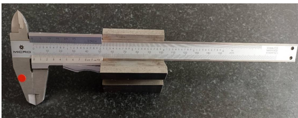
Rys. 6. Suwmiarka noniuszowa o rozdzielczości 0,02 mm.
