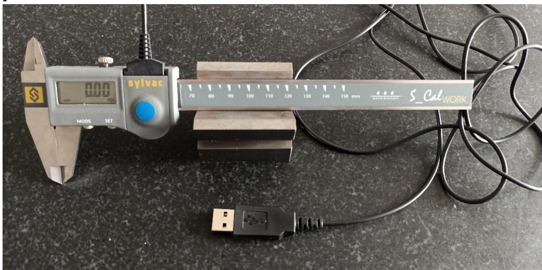
Rys. 8. Suwmiarka cyfrowa Sylvac z przewodowym wyjściem danych (port USB).
