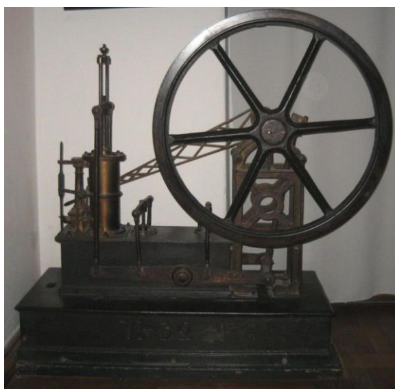
Rys. 12. Model prototypu maszyny parowej Jamesa Watta przystosowanej do przepompowywania wody
