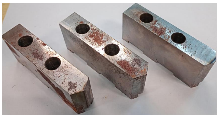
Rys. 9. Wymienny element chwytowy szczęki miękkiej dzielonej.
