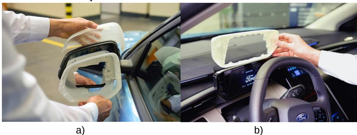
Rys. 1. Prototypowe modele podzespołów samochodu osobowego Ford Explorer wykonane z wykorzystaniem Druku 3D: a) element lusterka, b) element kokpitu.
