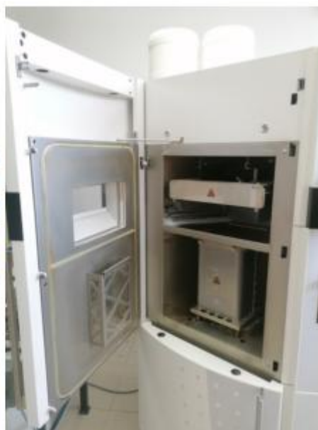
Rys. 8. Technologia SLS: a) wykonany model fizyczny, b) maszyna Formiga P 100 realizująca wydruki w technologii SLS.
