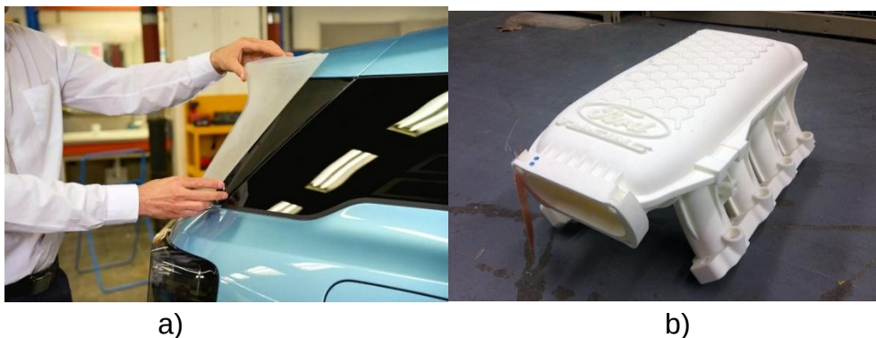
Rys. 3. Zastosowanie druku 3D w konstrukcjach aut marki Ford dla celów analizy aerodynamiki i przepływów: a) część zewnętrzna pojazdu osobowego b) element silnika spalinowego.
