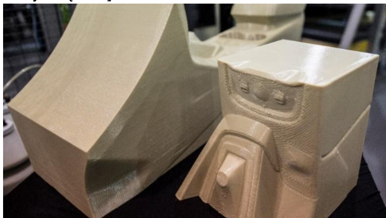
Rys. 2. Przykład wykonania technologią druku 3D wielkogabarytowych modeli do zastosowań w przemyśle motoryzacyjnym.
