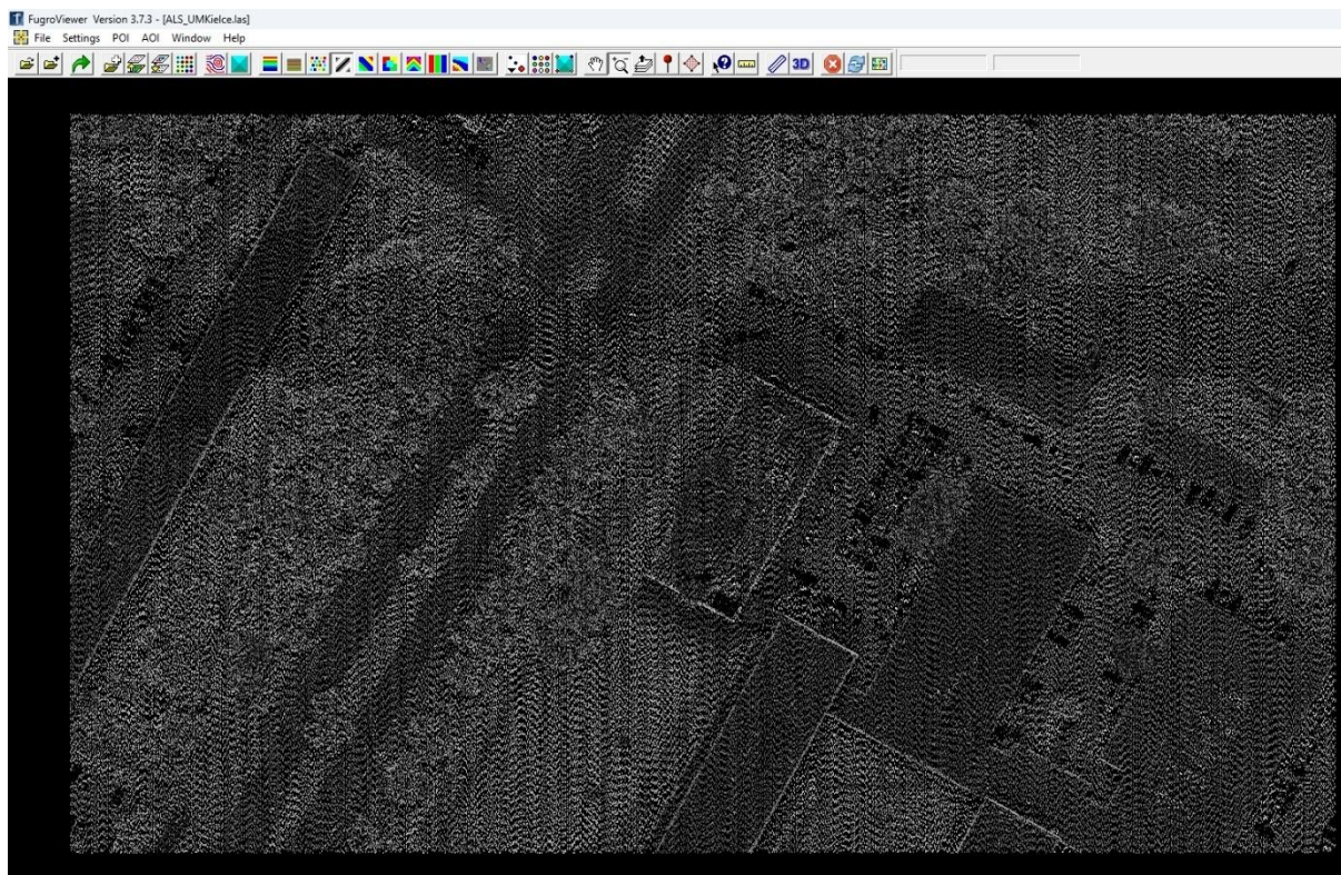
Rys. 4. Chmura punktów ALS kolorowana wg intensywności odbicia - skala szarości (oprac. własne na podstawie danych z UM Kielce)
