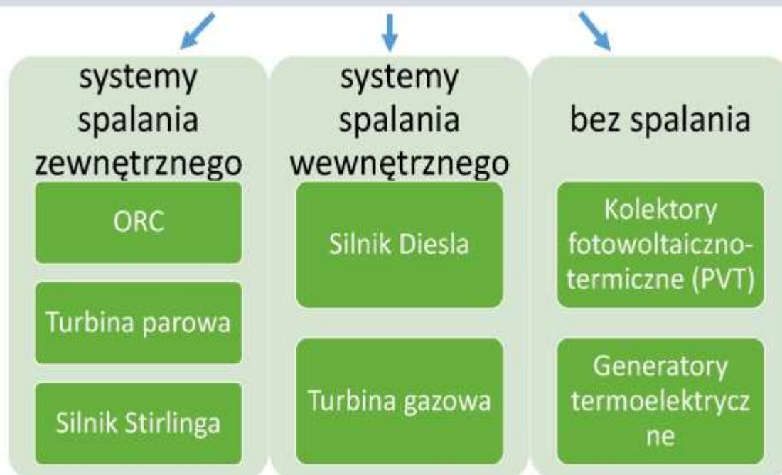
Rys. 2. Technologie konwersji w układach kogeneracyjnych.
