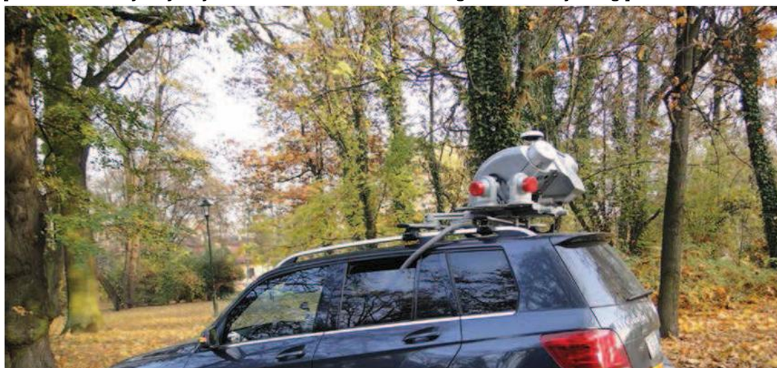
Rys. 3. System skanowania mobilnego zamontowany na dachu samochodu [2]
