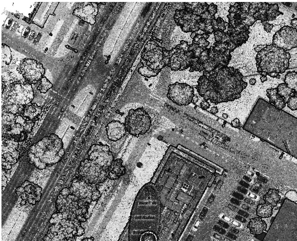
Rys. 22. Chmura punktów ULS – kolorowanie po intensywności.
